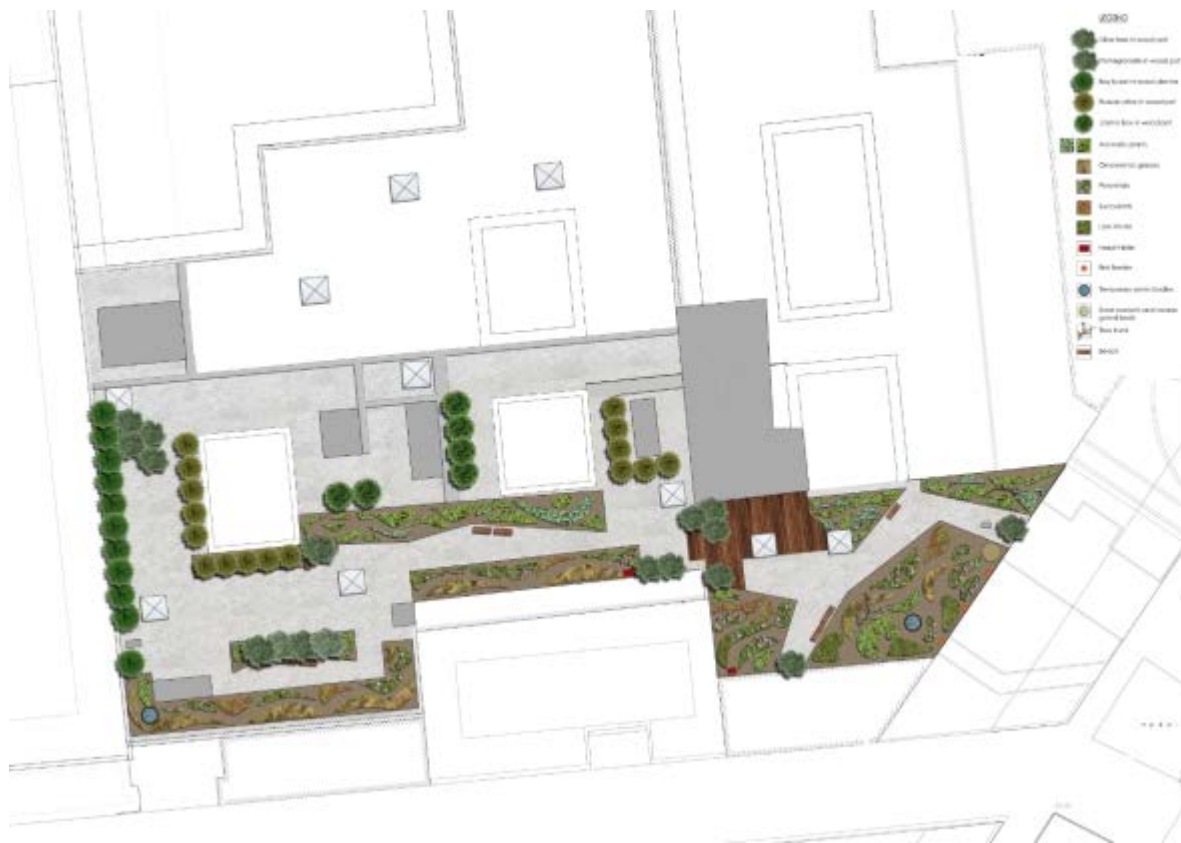
Σχήμα 11. Το σχέδιο της πράσινης στέγης
